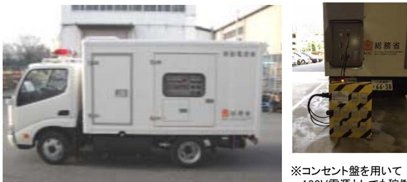
※コンセント盤を用いて100V電源としても稼働
