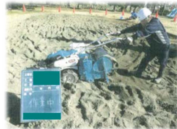
清掃機による攪拌・ふるいわけ作業
