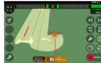
AgriBus-NAVI：トラクターやコンバインなどの農業機械に搭載し、広い圃場内で直進作業を支援するアプリ
