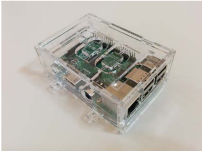
Raspberry Pi Kit を活用した接続モジュール。無線 LAN でデジタルファブリケーターをつなげる。
