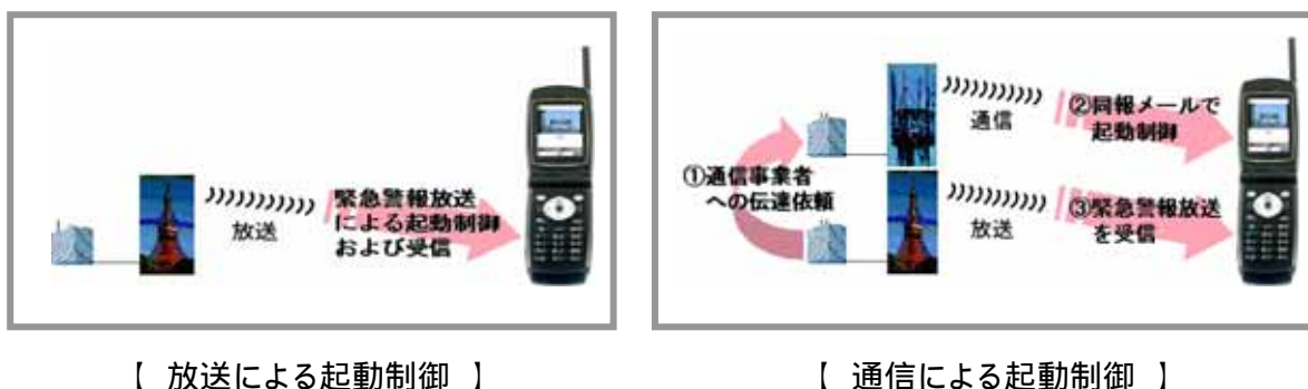
図 10 遠隔からの起動制御
