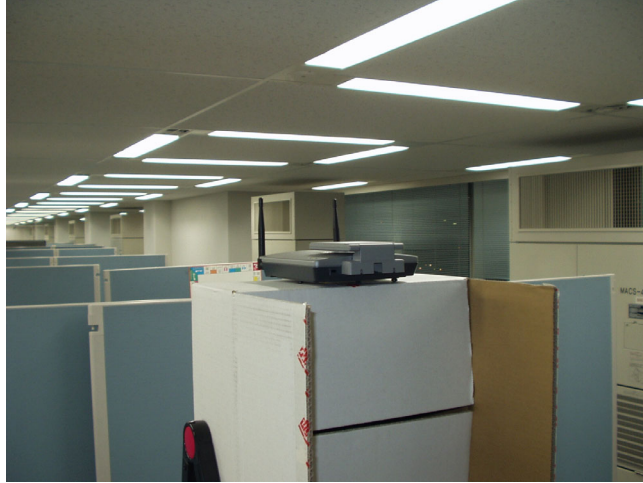
写真 2. 12 AP-1200 設置状況(横置)
