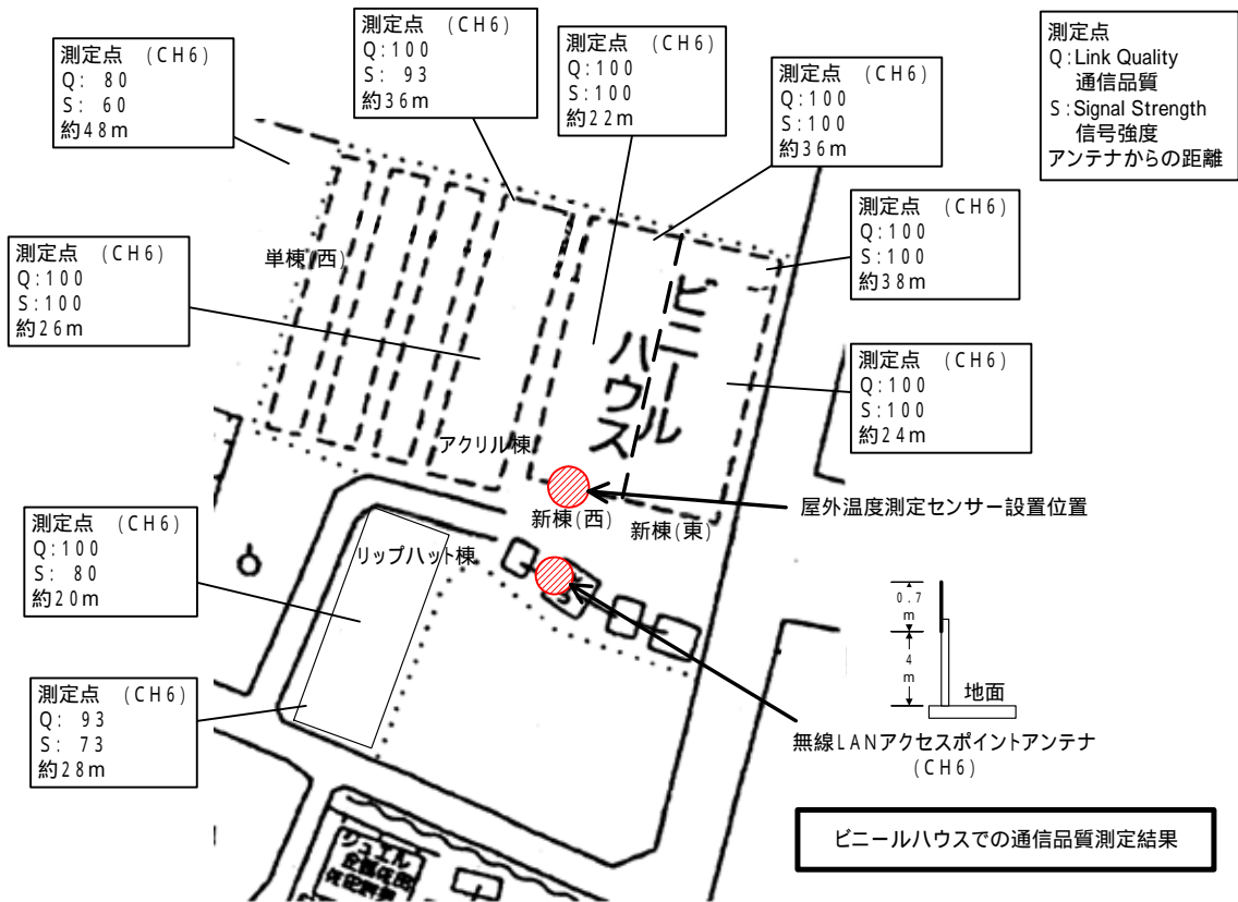
図 2-2-7 萩原洋蘭園（ビニールハウス）での通信安定性の実験結果
