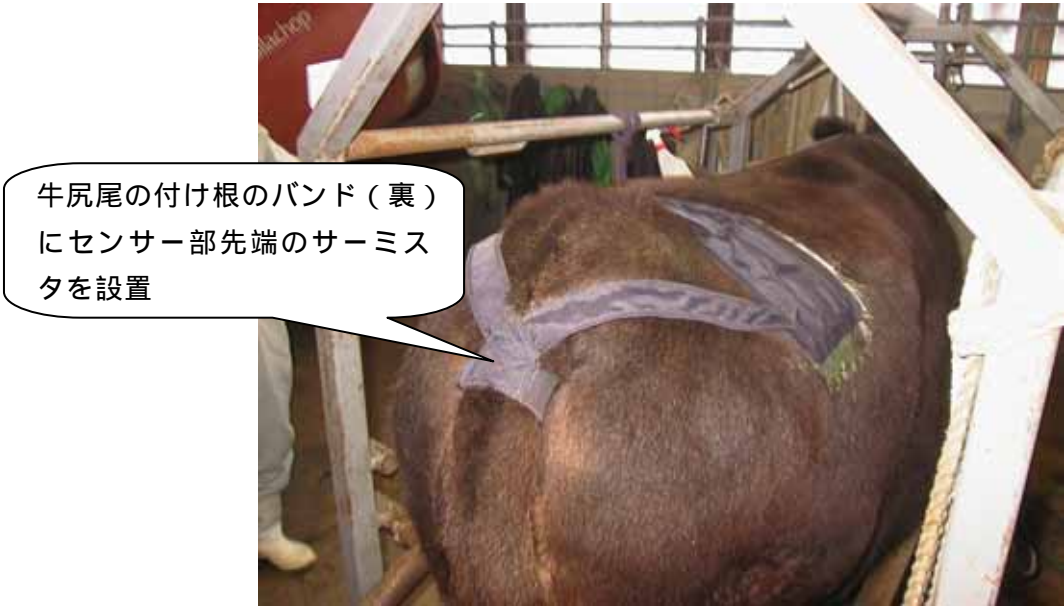
写真 2-6-1 IPv6 温度センサーを装着した牛
