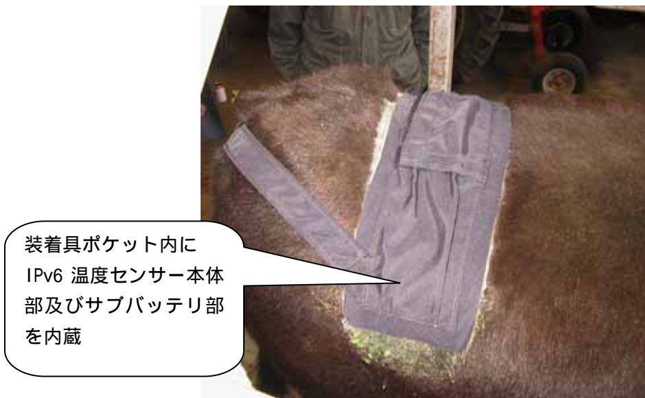
写真 2-1 岐阜県畜産研究所での牛への IPv6 温度センサー装着（1）
