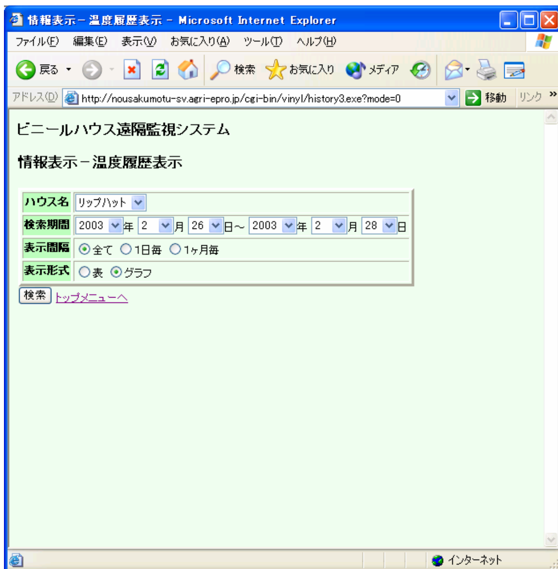
資料-図 2-3-9 ビニールハウス遠隔監視システム 温度履歴検索画面
