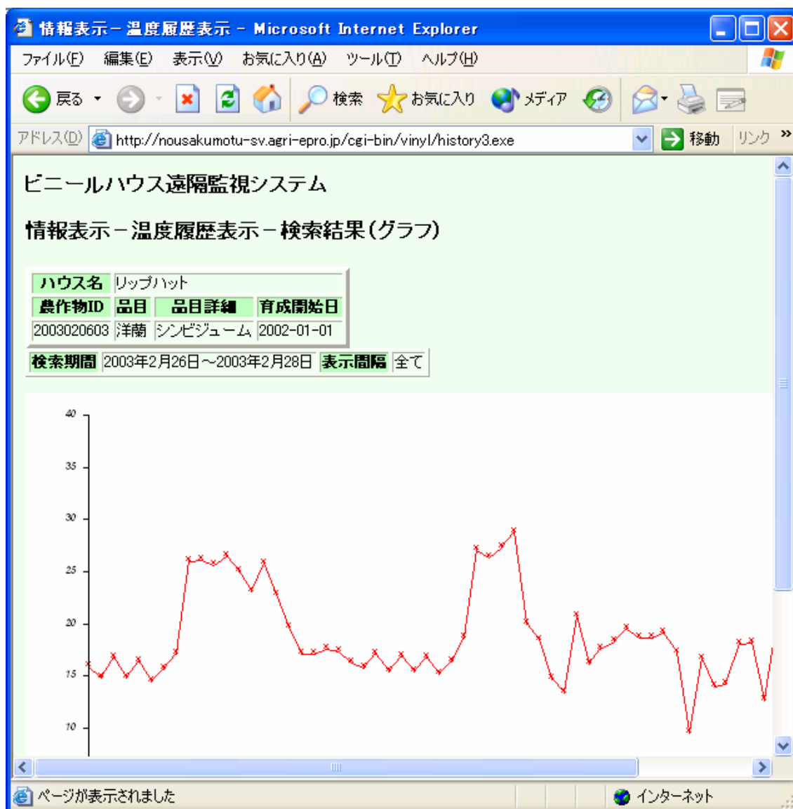
資料-図 2-3-11 ビニールハウス遠隔監視システム 温度履歴 (グラフ) 画面
