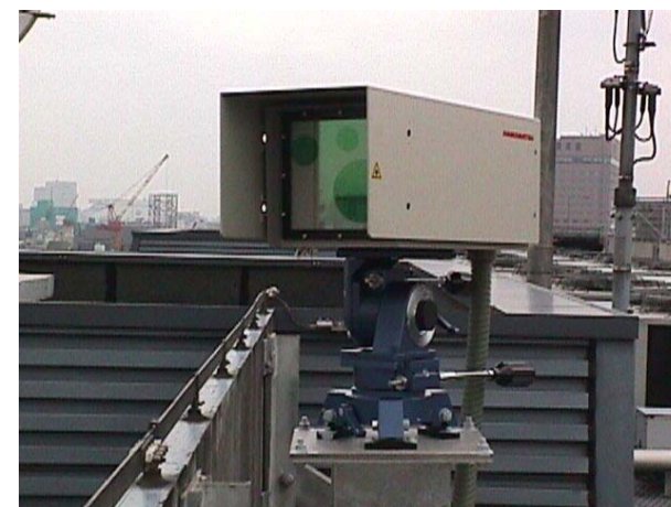
浜松ホトニクス製光無線伝播試験
