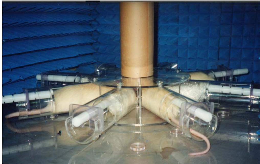
ラットの頭部への電波ばく露
