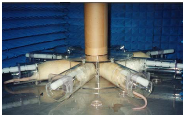
ラットの頭部への電波ばく露
