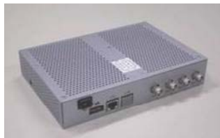
Ver1.0:ASV3 小牧実験装置 W 200 × H 35 × D 140 mm
