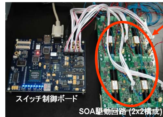
2x2光スイッチの動作検証構成
