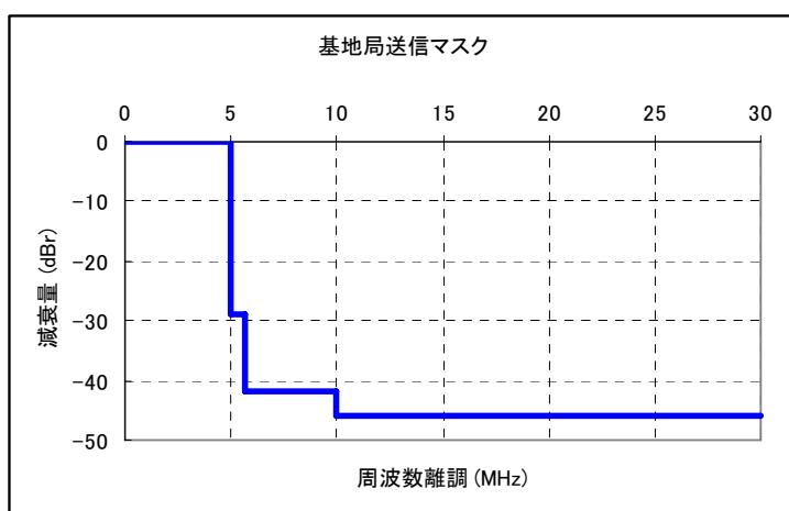
図 11 MBTDD-625k MC mode 基地局の送信マスク
