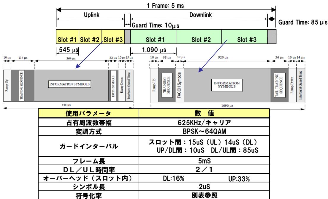
図 3.17 MBTDD 625k-MC フレーム構成
