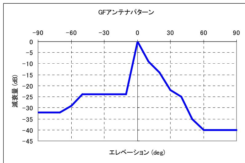
図3 ギャップフィラーのアンテナパターン
