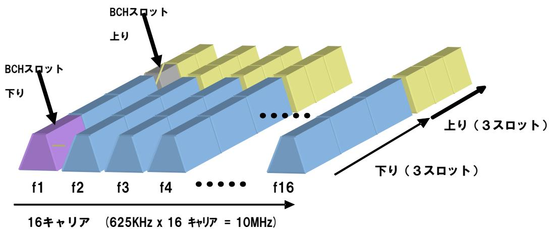
図 3.16 キャリア及びスロット構成のイメージ
