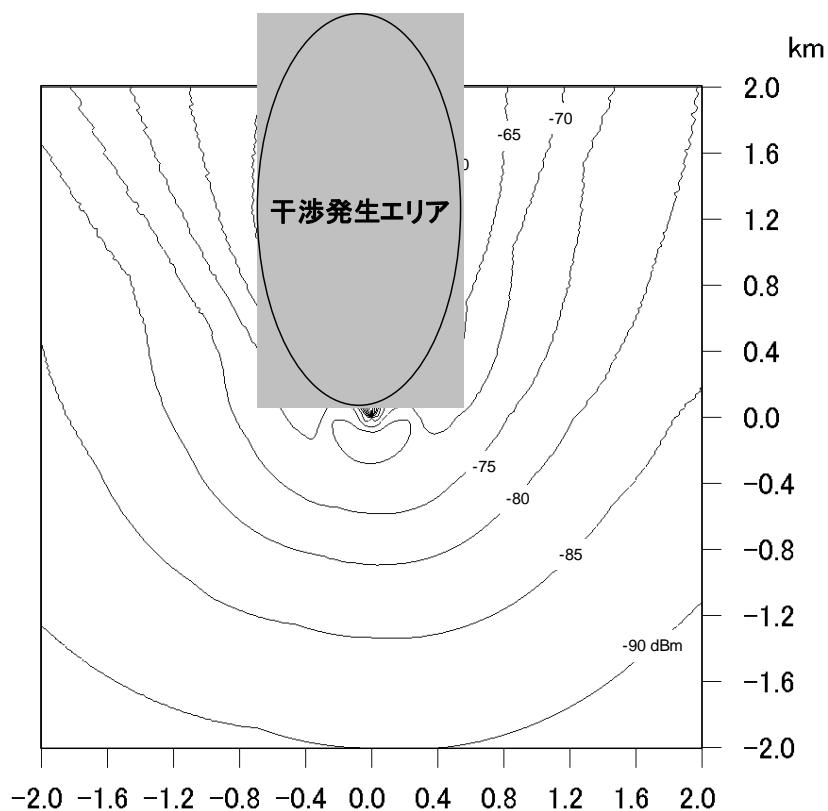
図 1 BWA 基地局が感度抑圧による干渉を及ぼす範囲
