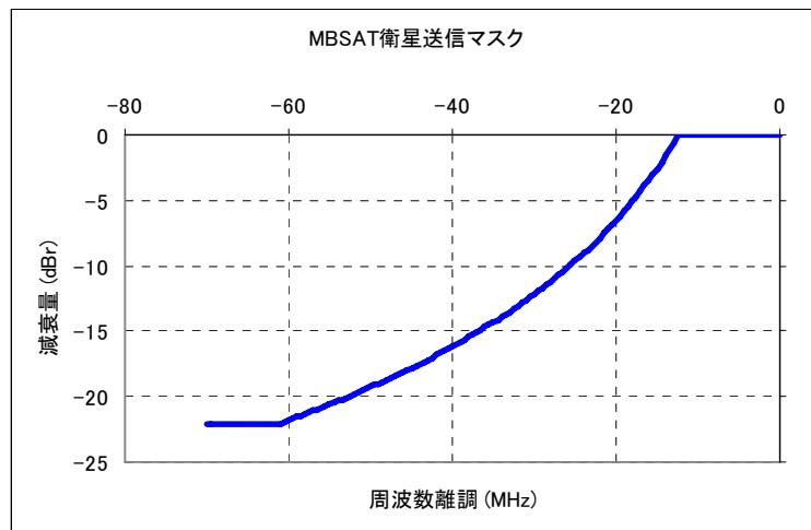
図 2 モバイル放送衛星送信マスク
