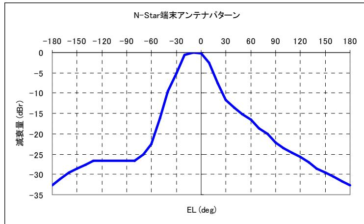
図 2 N-Star 端末のアンテナパターン
