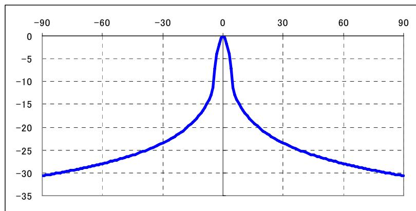
図 6 MBTDD-Wideband 基地局のアンテナパターン
