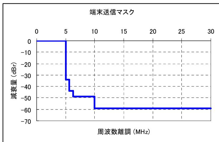
図 12 MBTDD-625k MC mode 端末の送信マスク
