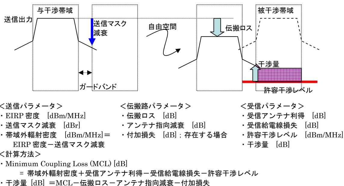
図 4.2 最悪値条件による計算のイメージ図
