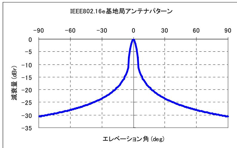
図 2 WiMAX 基地局のアンテナパターン
