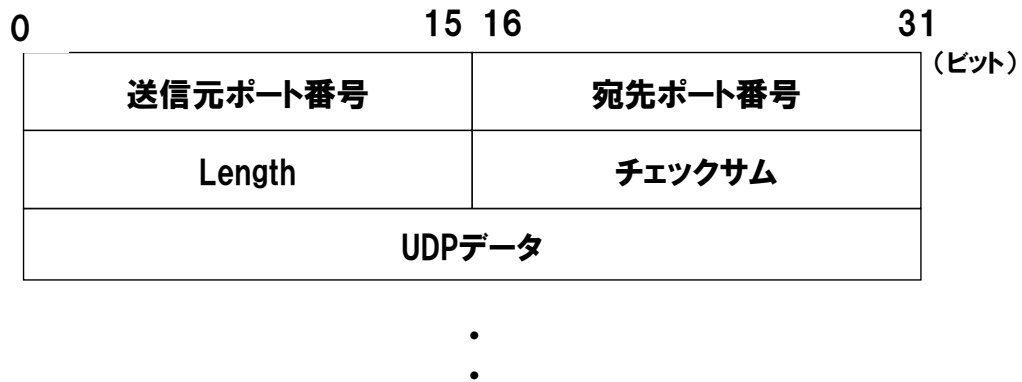
図 4-28 UDP ヘッダ構造
