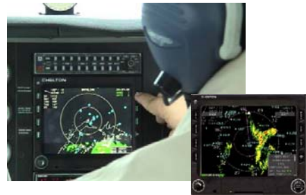
FIS-Bによる航空気象情報や空港情報レーダー画像情報を表示
