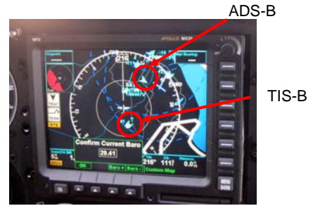
TIS-B・ADS-Bによって得られる他機位置情報をコックピットディスプレイに表示
