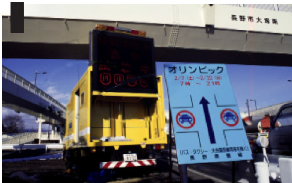
情報コンセントに接続して、道路状況を知らせるLTD標識車。
