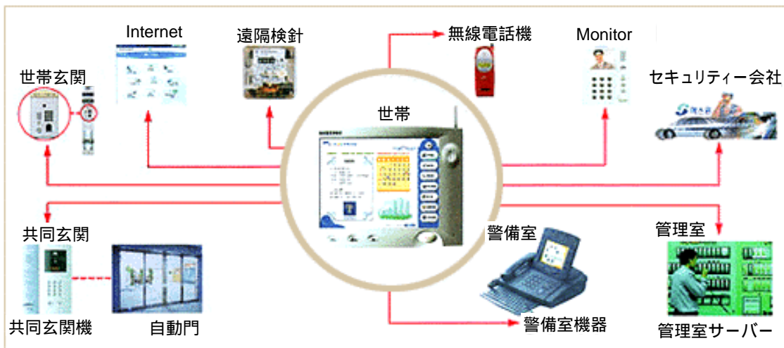
図 4-2-8 タワーパレスのホームネットワークシステム構成図
