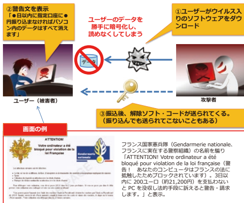
図表 4-3-2-16 ランサムウェアの仕組み
