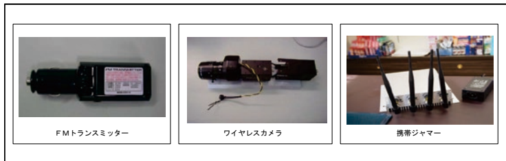
図表6-2-3-6 無線通信に障害を与えた不適合機器の例
