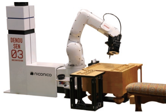
図表4-1-3-12 プロ棋戦専用ロボットアーム「電王手くん」
