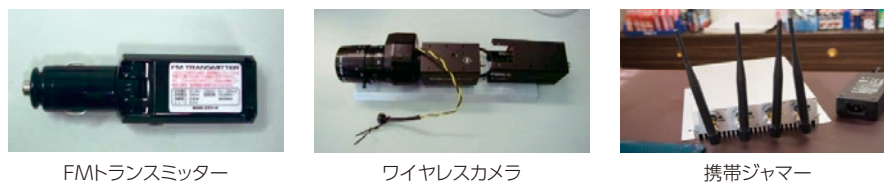
図表 8-3-3-2 無線通信に障害を与えた不適合機器の例
