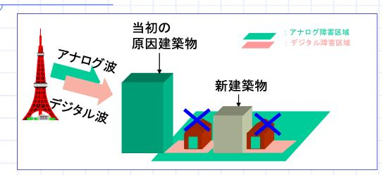
当初+新建築物による遮蔽障害モデル(アナログ遮蔽障害地域)
