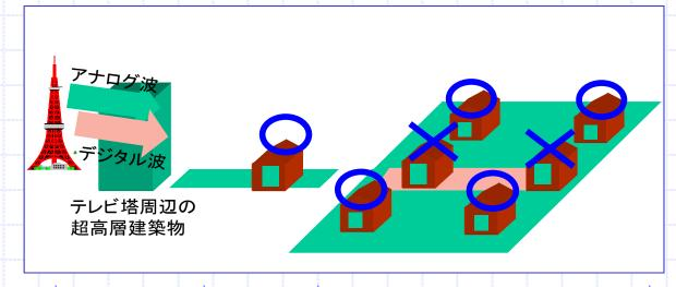
超高層建築物による遠方地域での電界強度低下モデル
