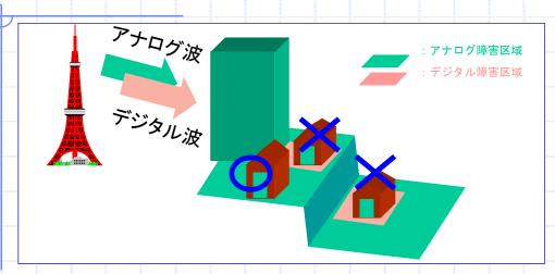
当初建築物十地形障害モデル 当初の原因建築物の直近と地形による受 信障害があるケース
