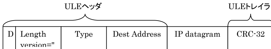
図 3.1.5.4-44 ULE パケット構造
