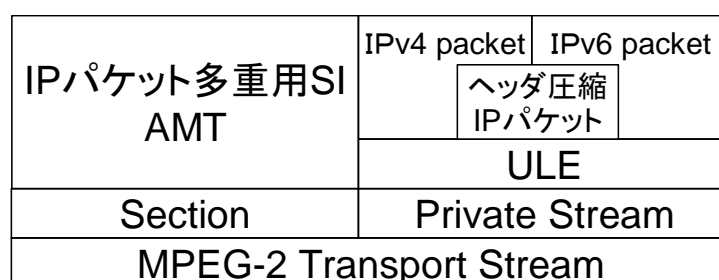
図3.3.5.4.2-1 IPパケット多重化方式のプロトコルスタック
