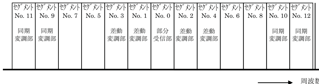
図 3.1.6.14-1 伝送スペクトル上の OFDM セグメント No. と使用例 (13セグメント形式)
