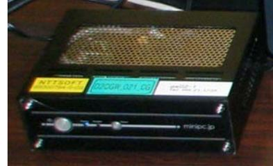
写真 3.2-2 SIP 連動型ブロードバンド接続ゲートウェイ装置 (GW 装置)
