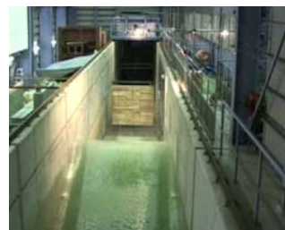
大型実験施設での津波実験
