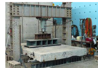
老朽化部材の破壊試験によるライフサイクルマネジメントシステムの構築
