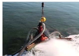
有孔管簡易浚渫装置による海浜の土砂輸送実験
