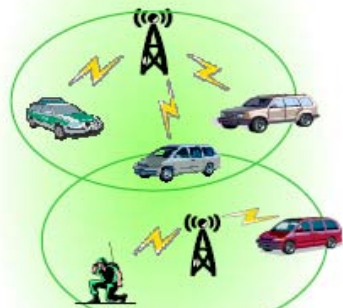
集中制御通信モード (常設基地局－移動端末間通信)
