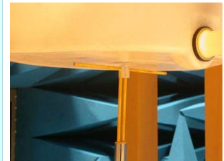
ダイポールアンテナを用いた簡易性能試験
