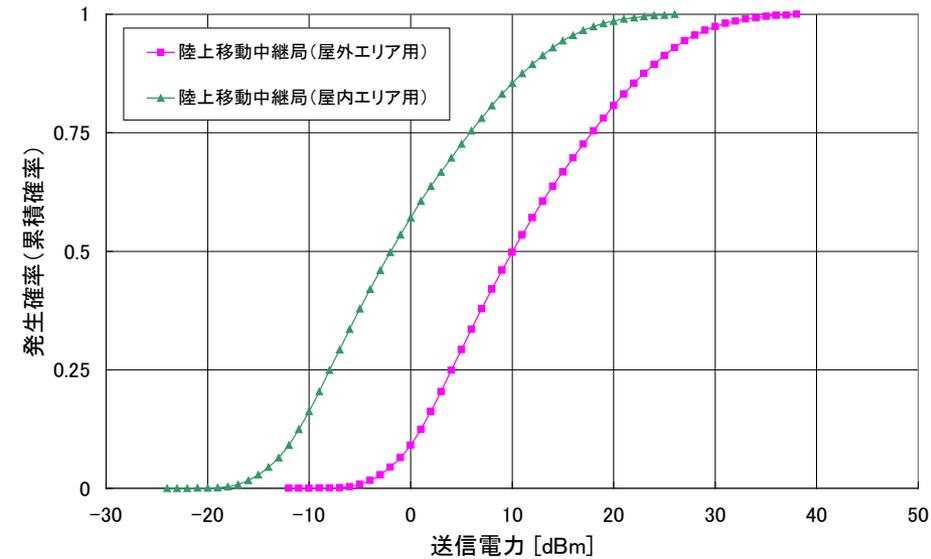
図2-11.陸上移動中継局送信電力分布
