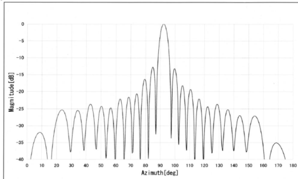
図3-1. MCA陸上移動中継局の送受信アンテナ特性1
