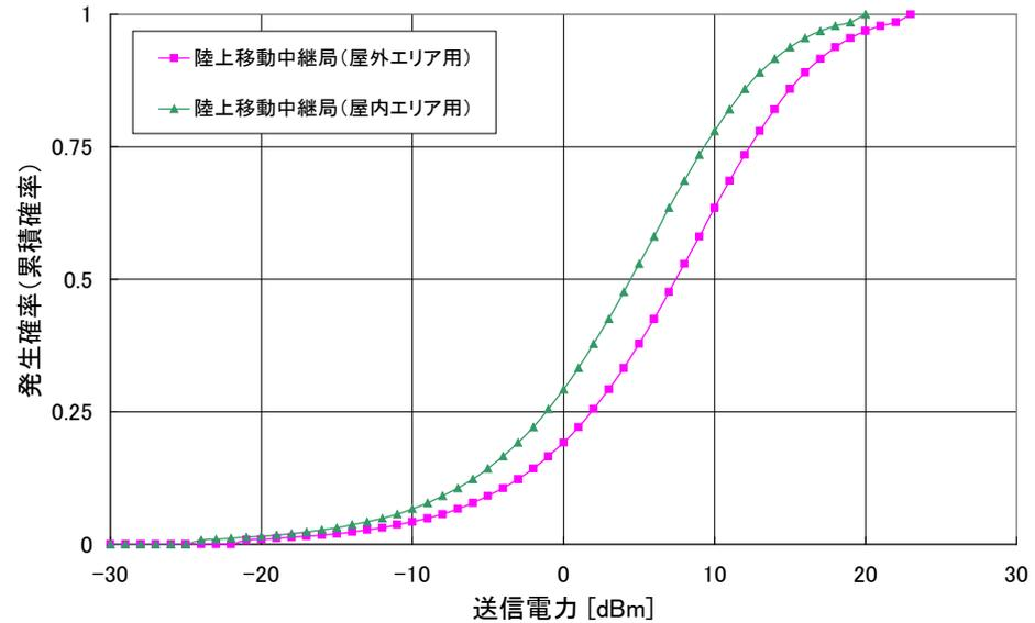
図2-12.陸上移動中継局送信電力分布
