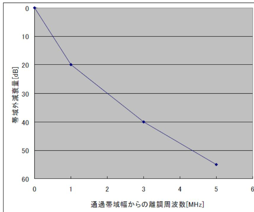
図3-5. MCA陸上移動中継局の受信フィルタ特性
