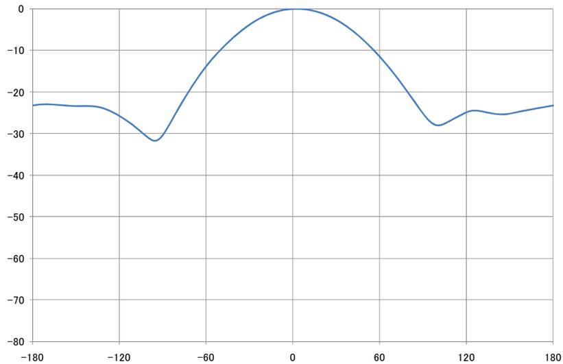
図B-2 小電力レピーターアンテナ指向特性(垂直)
