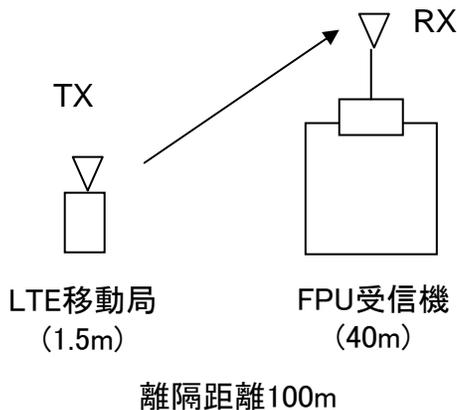
※受信アンテナ指向方向はLTE移動局方向として検討
