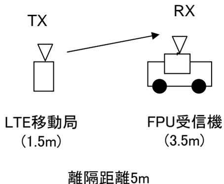
※受信アンテナ指向方向はLTE移動局方向として検討
