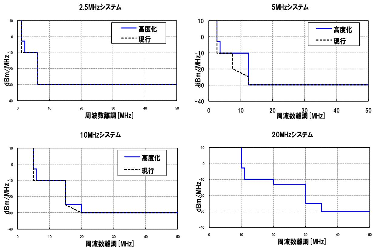
図 3.6 XGP 移動局における隣接チャネル漏洩電力及びスペクトラムマスク
