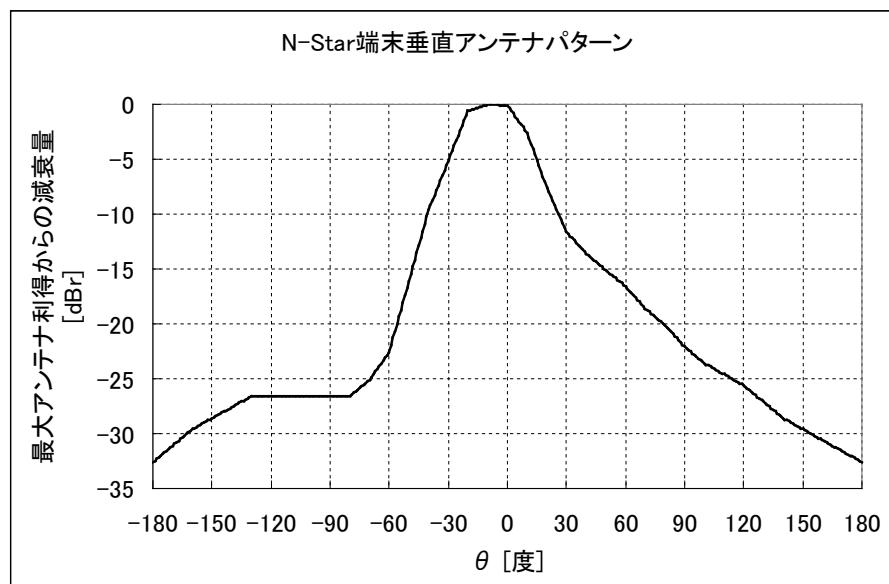
参図 3 N-Star 端末のアンテナパター
