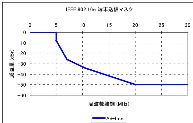
参図 2 高度化 WiMAX 端末送信マスク
