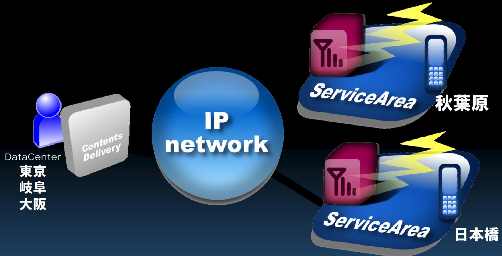
配信機能を集中化し、配信拠点（データセンター）から離れた複数のサービスエリア（送信機）に対してIPネットワークを活用してコンテンツ配信や運用を行う広域配信機能の実現性を検証する。
