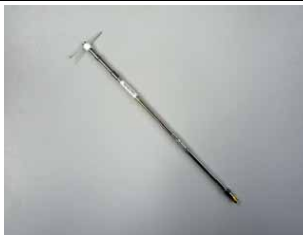
図 1-2 試験に用いた半波長ダイポールアンテナ (アンリツ社製 : MA5612B5)
