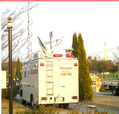
Jヴィレッジのエリア化 (楢葉町内 4月1日衛星移動基地局車を設置)
