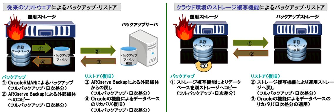
図 2-31 オンサイトバックアップ構成概要
