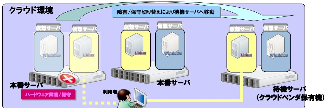
図 2-37 障害切替の概要
