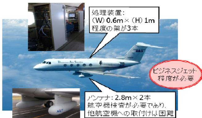
小型航空機搭載用 高分解能合成開口レーダー
