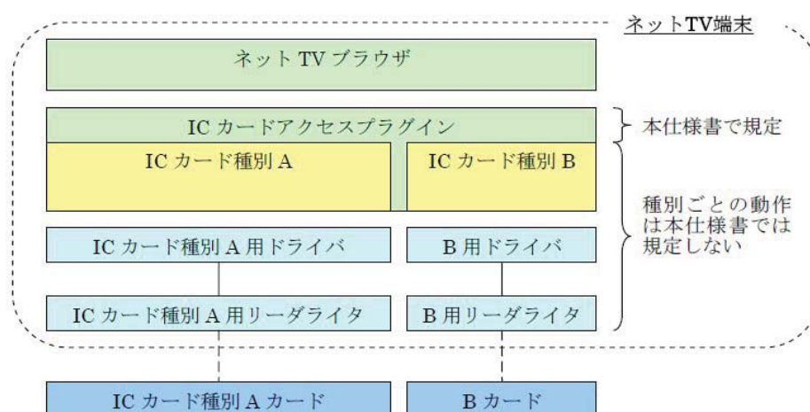
図 6-1 IC カードアクセス機能を実現するための構成要件
