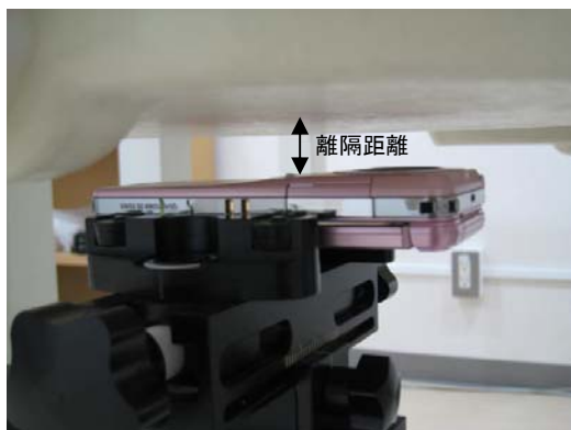
図 6.1 測定対象無線機器の設置例
