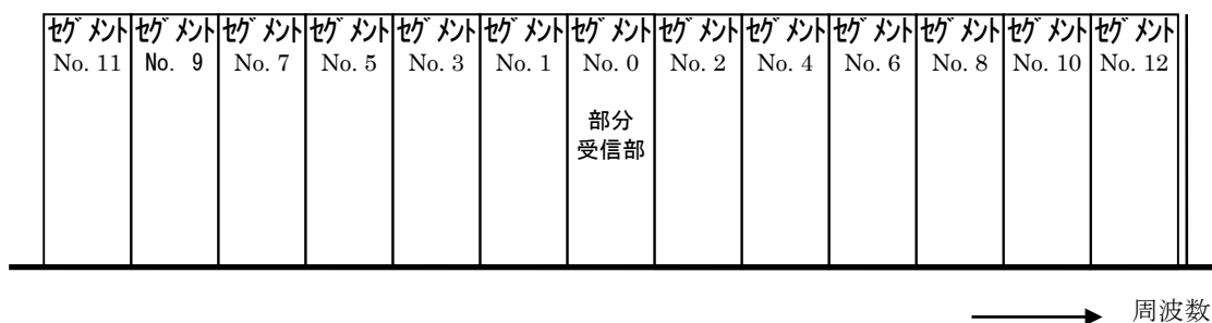
図 2.4-33 伝送スペクトル上の OFDM セグメント No (フルセグ型)
