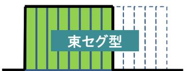
束セグ型                | $(6000/14 \times n + 38.48) \text{kHz}$<br>※セグメント連結送信<br>n: 連結したセグメント数 | エリア限定、複数ワンセグを束ねて放送。                                      |
