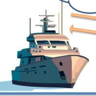
レーダーは、電波の反射波が戻ってくる 時間で測位する。
