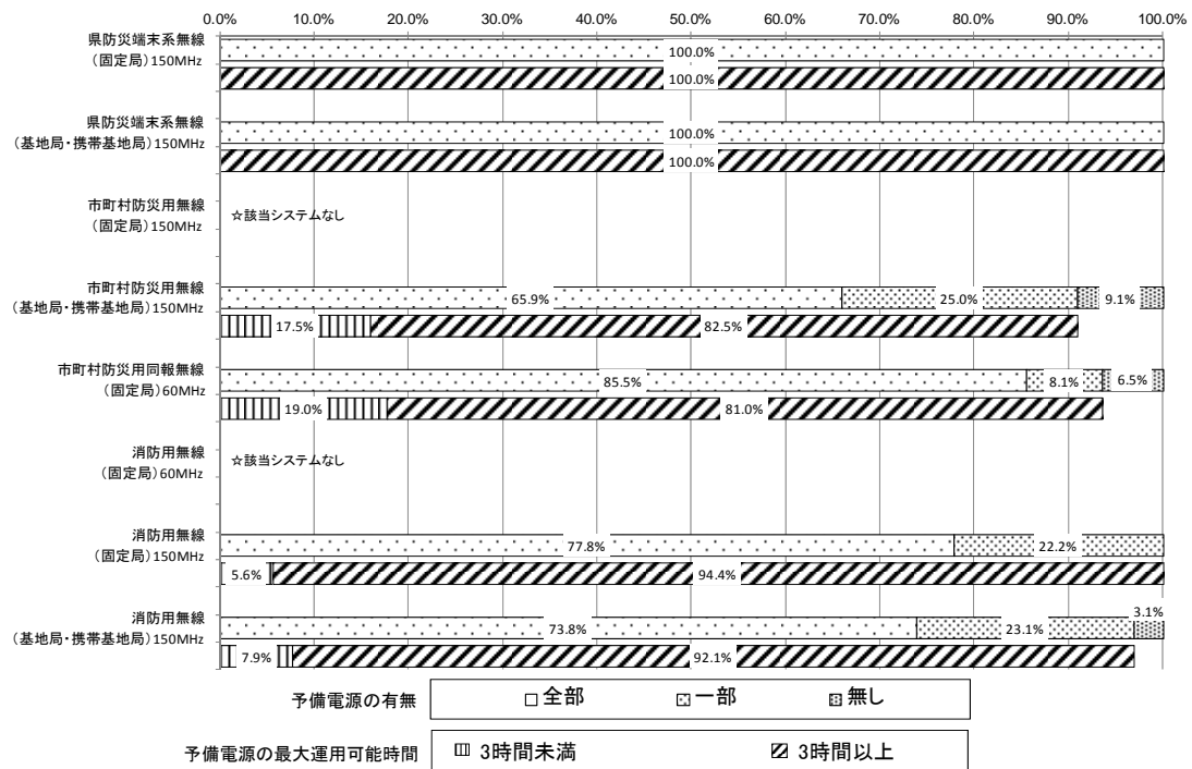
図表－9－4－20 予備電源保有状況及び予備電源の最大運用可能時間 (県防災端末系無線・市町村防災用無線・消防用無線)(内訳)【四国】
