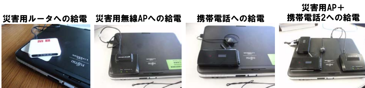
図 123 タブレットPCから災害用ルータへの給電
