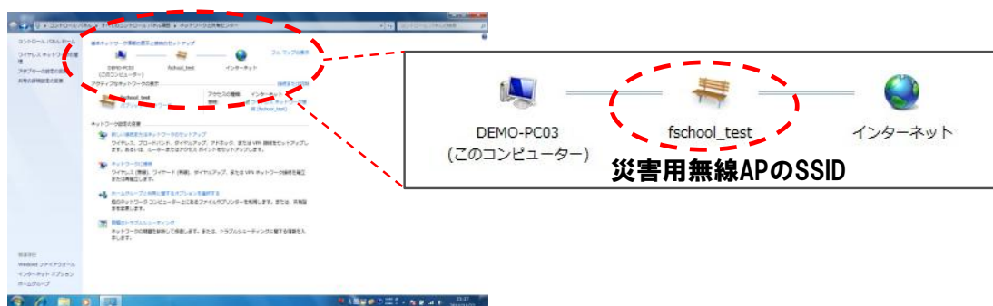
図 120 パターン2:校舎内と体育館に電源が確保されていない状況での接続確認
