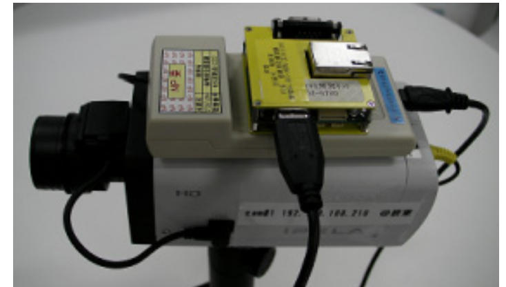
開発したインテリジェントカメラ試作機 (特徴量抽出等の前処理をカメラ側に実装)
