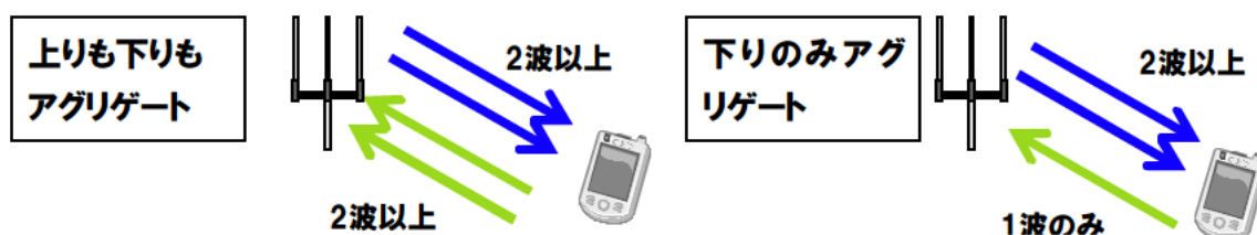
図3. 1—2 キャリアアグリゲーション形態（上りと下り）
