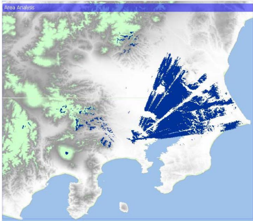
図 2. 5. 3-12 地球局 A : 同一チャネル干渉の結果 (小セル基地局、短時間干渉)
