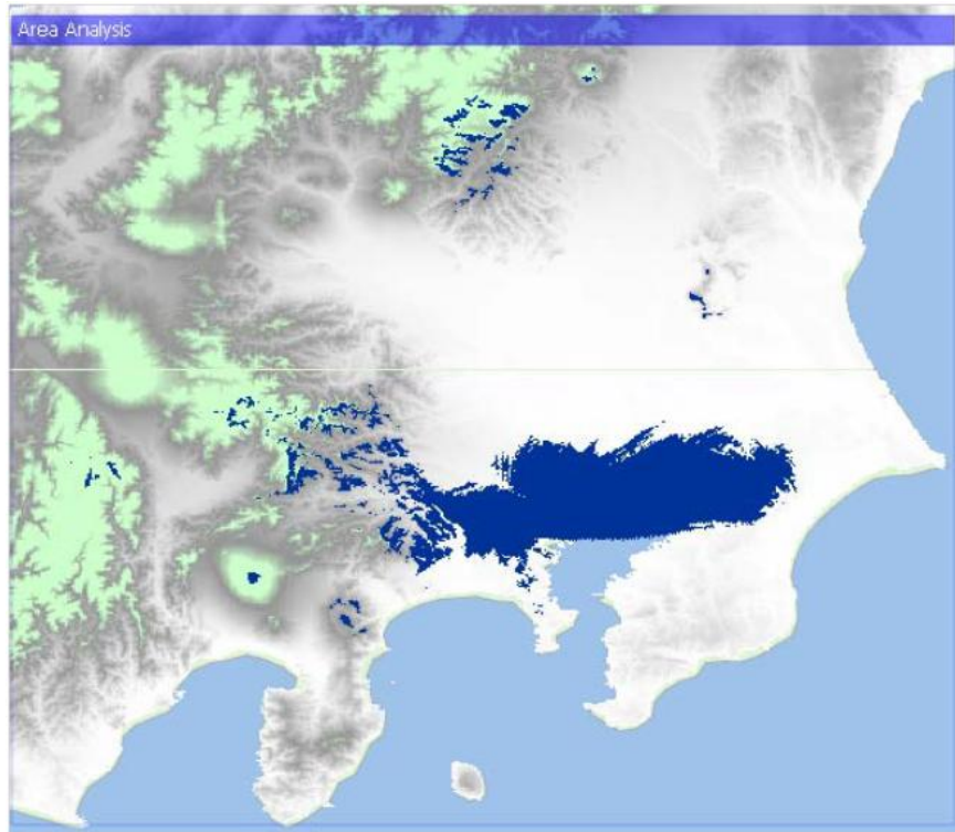
図 2. 5. 3-7 地球局 A : 同一チャネル干渉の結果 (通常基地局、長時間干渉)
