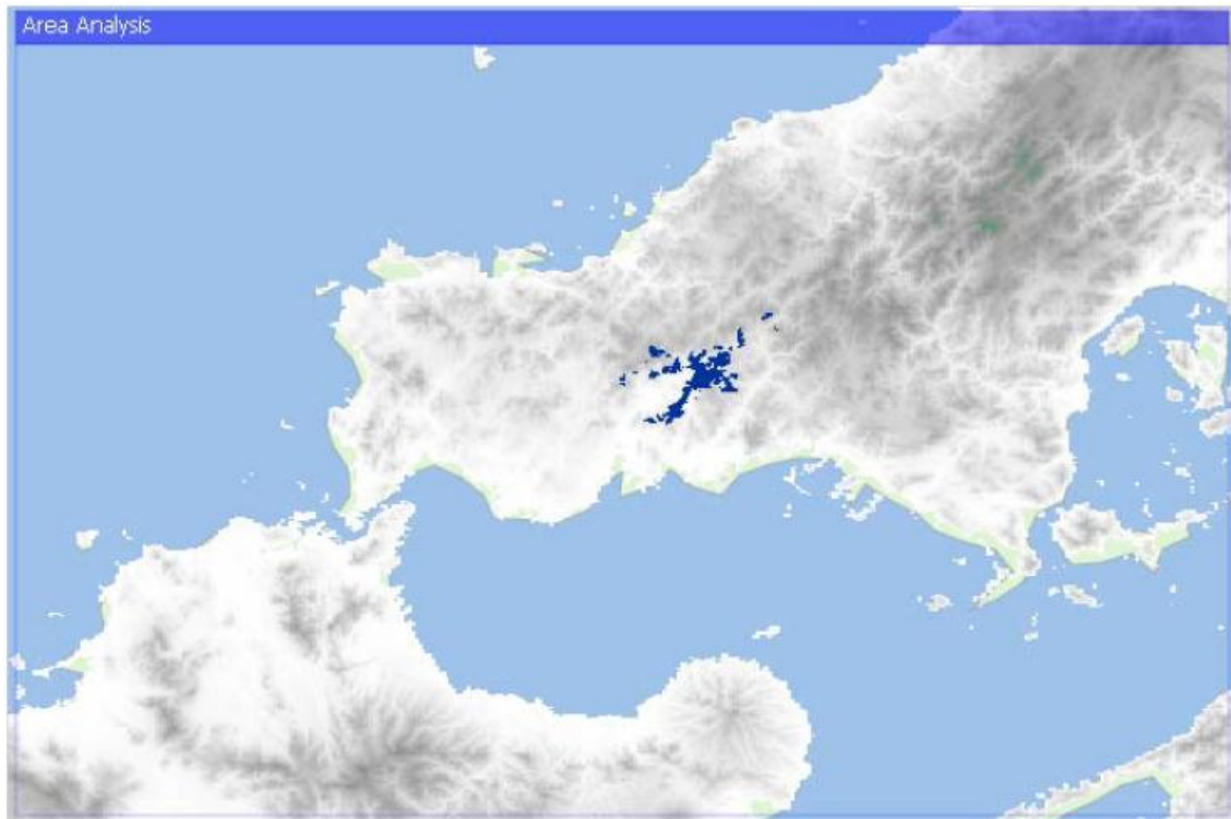
図 2. 5. 3-19 地球局 B : 同一チャネル干渉の結果 (小セル基地局、長時間干渉)
