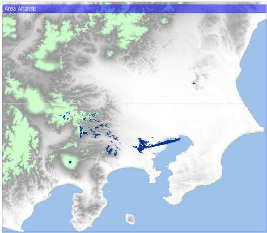
図 2. 5. 3-11 地球局 A : 同一チャネル干渉の結果 (小セル基地局、長時間干渉)
