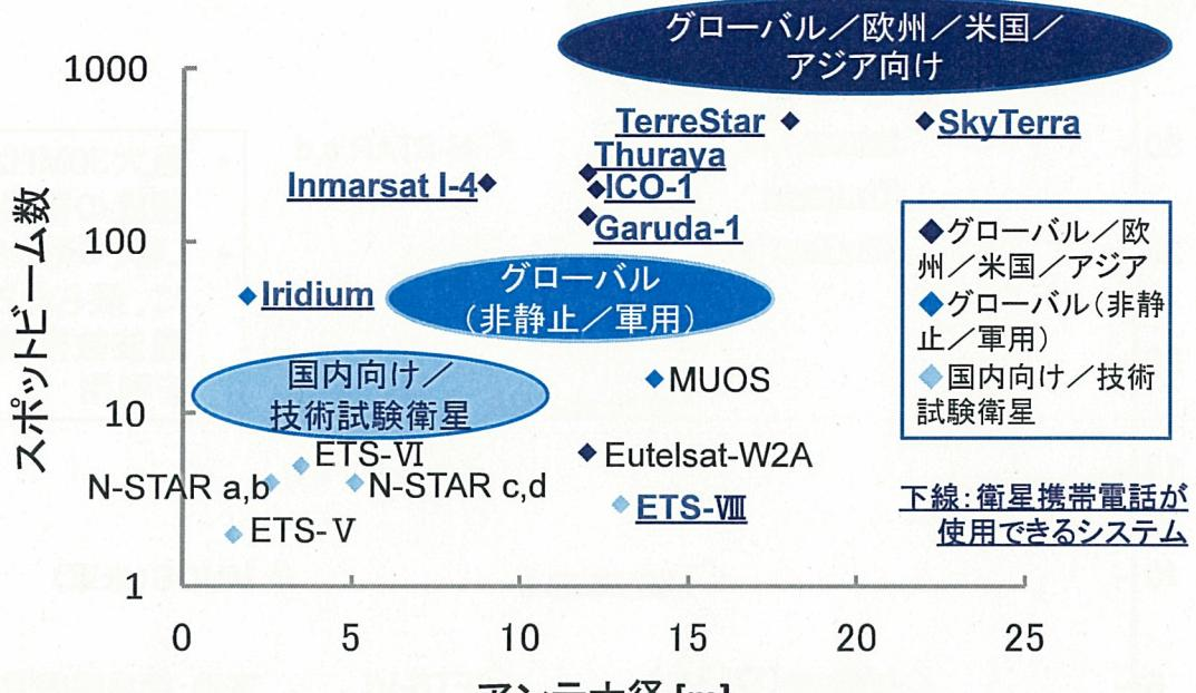
■ 広域サービスでのスポットビーム数の増大の背景には、端末の小型化を可能とする衛星アンテナの大口径化技術の進展に伴うスポットビームサイズの低減周波数繰り返し利用による回線収容力の向上効果がある。
