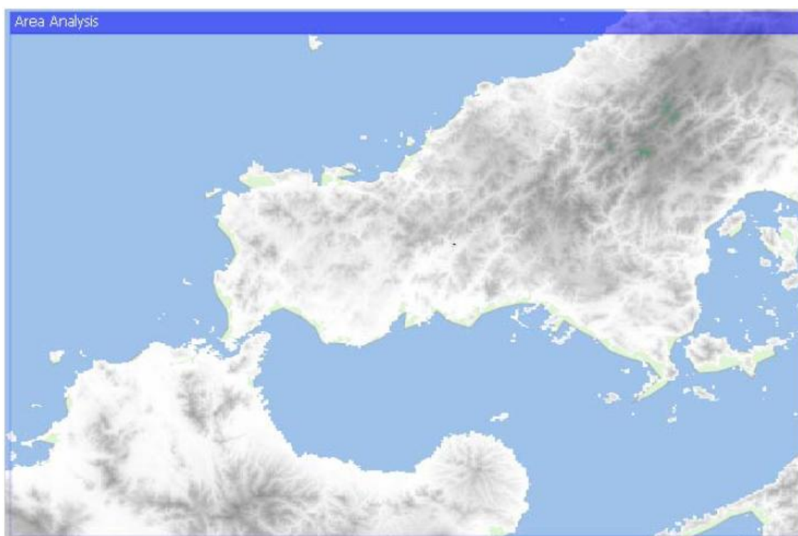
図 2. 5. 3-22 地球局 B : 隣接チャネル干渉の結果 (小セル基地局、短時間干渉、45dBc の不要発射レベル)
