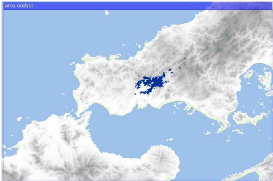
図 2. 5. 3-15 地球局B：同一チャネル干渉の結果（通常基地局、長時間干渉）
