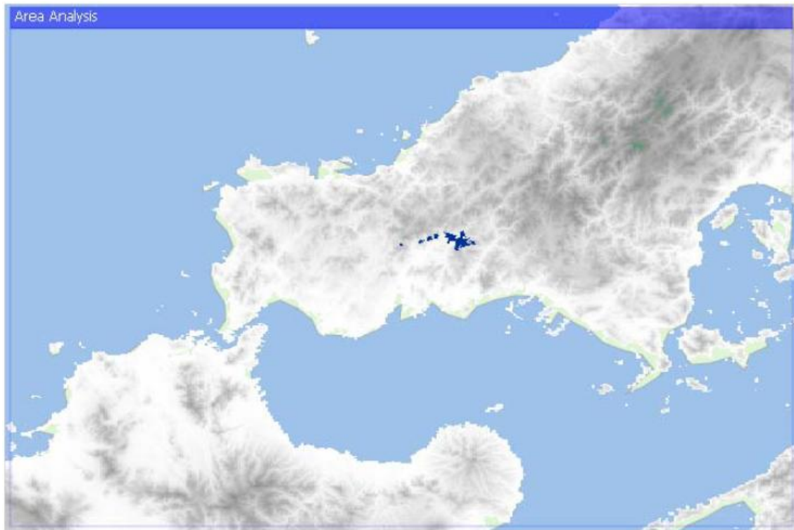
図 2. 5. 3-18 地球局 B : 隣接チャネル干渉の結果 (通常基地局、短時間干渉、45dBc の不要発射レベル)
