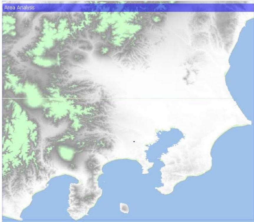
図 2. 5. 3-13 地球局 A : 隣接チャネル干渉の結果 (小セル基地局、長時間干渉、45dBc の不要発射レベル)
