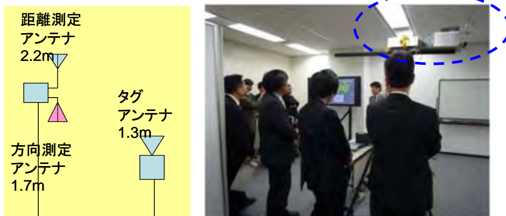
図 50 リーダ装置とタグ装置のアンテナ高さ関係
