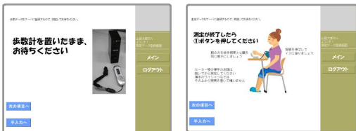
(左) 歩数計の登録画面 歩数計をかざすだけで個人認証を実施。同時に歩数データを読み取り、送信します。 (右) 体重と血圧の測定画面 テレビ電話の前で血圧・体重測定を行うだけ。計測したバイタルデータが自動で送信されます。
