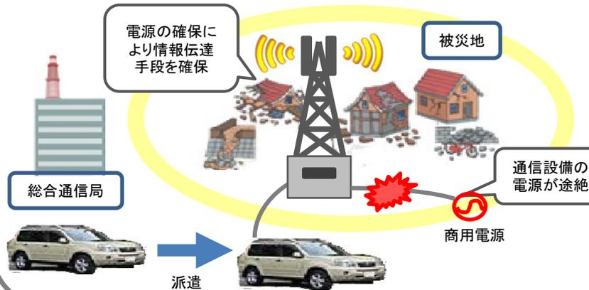
小型電源車は、最大定格出力 单相100V 5.5KVAの性能を持ち、防災行政無線の中継局や放送の中継局等に供給できる仕様であり、ドラムケーブルや丸形端子接続による供給方式となっている。
