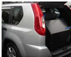
◆ 小型電源車の差し込みコンセントにドラムケーブル(約120m延長可能)を接続、その出力を避難所等において使用する。
